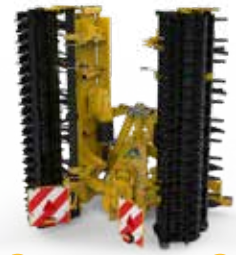
ΜΕΤΑΦΟΡΑ ΣΤΟΝ ΔΡΟΜΟ 2,50 Μ
